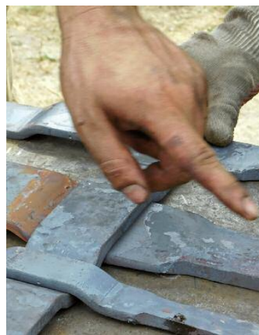
Die Flacheisen mit den Erhebungen und Vertiefungen wurden auf dem Richttisch mitten auf dem Schmiedepplatz für die Zuschauer nachvollziehbar zusammengelegt - im Feuer konnten noch leichte Korrekturen vorgenommen werden, die gestalteten Enden der Lehne wurden ebenfalls ausgeschmiedet
