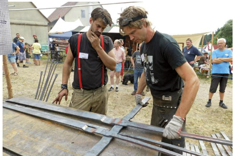
Die Flacheisen mit den Erhebungen und Vertiefungen wurden auf dem Richttisch mitten auf dem Schmiedepplatz für die Zuschauer nachvollziehbar zusammengelegt - im Feuer konnten noch leichte Korrekturen vorgenommen werden, die gestalteten Enden der Lehne wurden ebenfalls ausgeschmiedet
