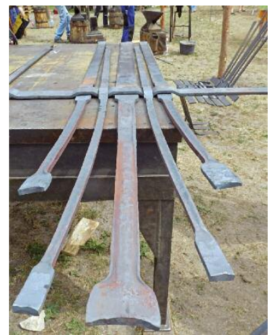
Die Flacheisen mit den Erhebungen und Vertiefungen wurden auf dem Richttisch mitten auf dem Schmiedepplatz für die Zuschauer nachvollziehbar zusammengelegt - im Feuer konnten noch leichte Korrekturen vorgenommen werden, die gestalteten Enden der Lehne wurden ebenfalls ausgeschmiedet
