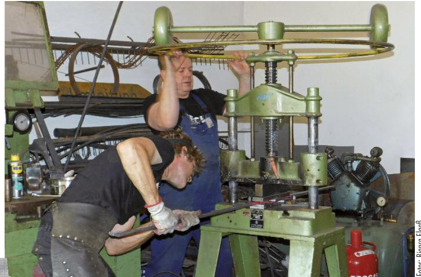
Mit der Spindelpresse in der Werkstatt von Peter Brunner wurden die vorher präzise angerissenen Vertiefungen in die Flacheisen-Stäbe eingepresst
