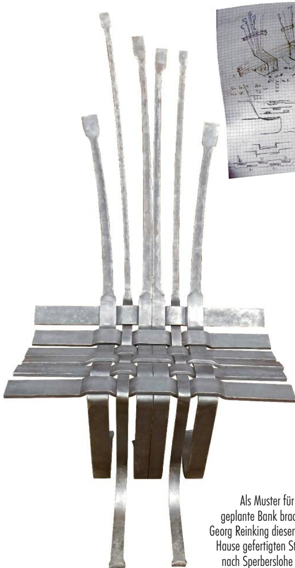
Die Flacheisen mit den Erhebungen und Vertiefungen wurden auf dem Richttisch mitten auf dem Schmiedepplatz für die Zuschauer nachvollziehbar zusammengelegt - im Feuer konnten noch leichte Korrekturen vorgenommen werden, die gestalteten Enden der Lehne wurden ebenfalls ausgeschmiedet
